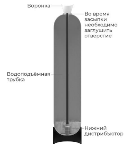
Заполнение фильтра материалом
