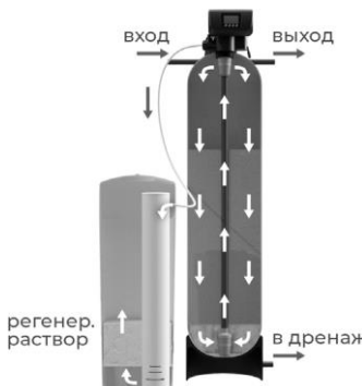
4. Заполнение водой реагентного бака
